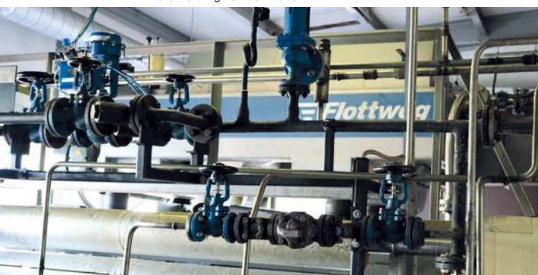
Tricanter® Komplettsystem mit Erhitzung zur Verarbeitung von Leimleder
