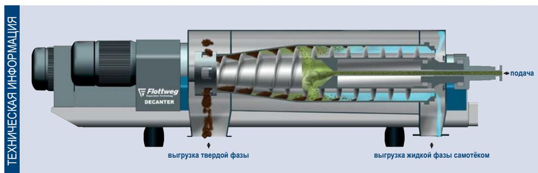
Декантер Flottweg для разделения жидкого и твердого вещества с выгрузкой жидкой фазы (фугата) под действием силы тяжести
