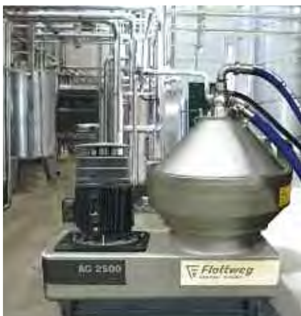
Сепаратор FLOTTWEG AC 2500 для осветления сока и вина
